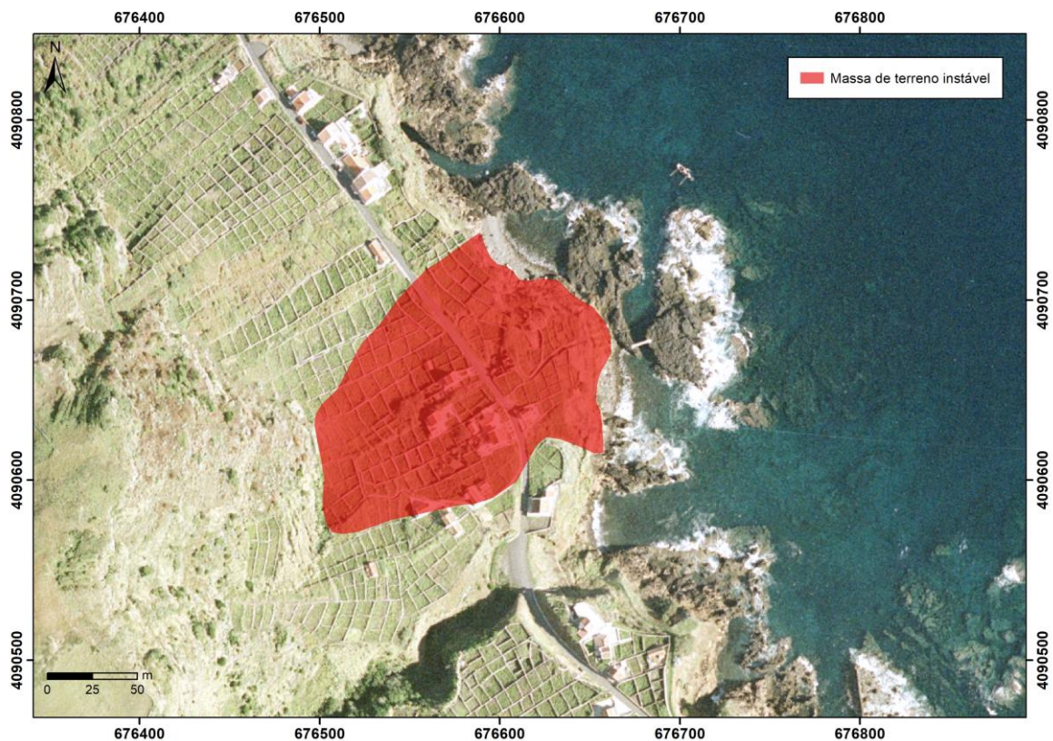
Figura 8 – Localização das massas de terreno instabilizadas na Maia, abrangida pelas redes de monitorização.
