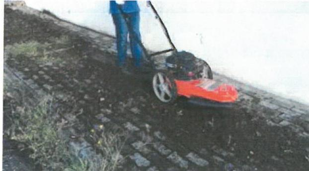
**Figura 9** – Roçadora adaptada com uma escova de aço
